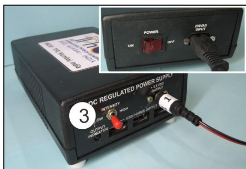
Slika 4: Nastavljiv napajalnik (DC) za laser.
